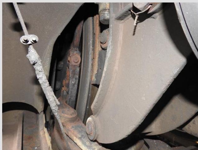
Figur 17: Skadet parkbrems. Foto: SHK
