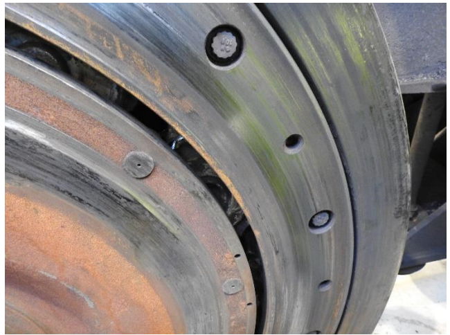
Figur 24: Havarert gummielement på SAB-hjul. Foto: SHK
