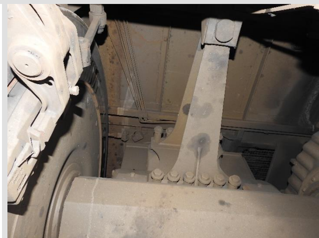
Figur 11: Uskadd motorfeste for motor 2. Foto: SHK
