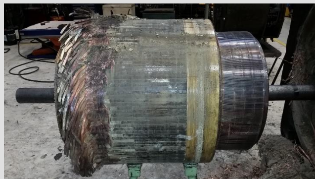
Figur 9: Rotor med skadete viklinger. Foto: CargoNet AS
