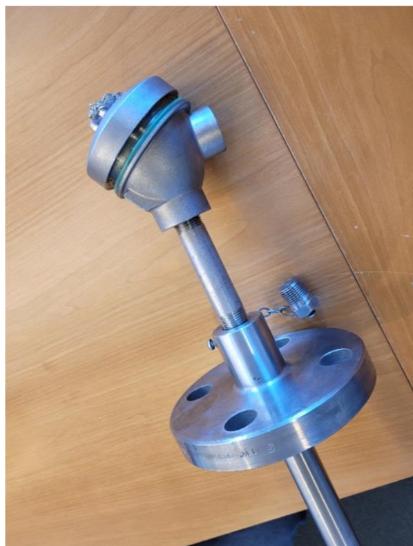
Figur 5 Prinsippskisse termolomme og bilde av 1" termolomme hentet fra lageret på Mongstad. Foto: Ptil
